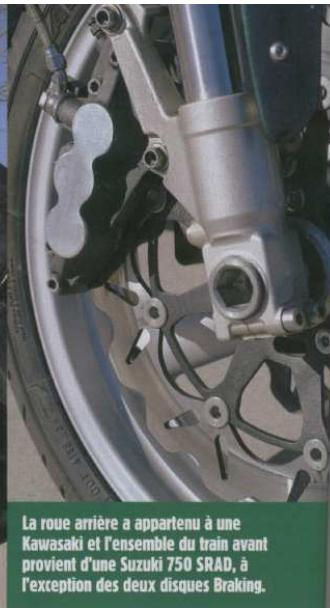
La roue arrière a appartenu à une Kawasaki et l'ensemble du train avant provient d'une Suzuki 750 SRAD, à l'exception des deux disques Braking.
